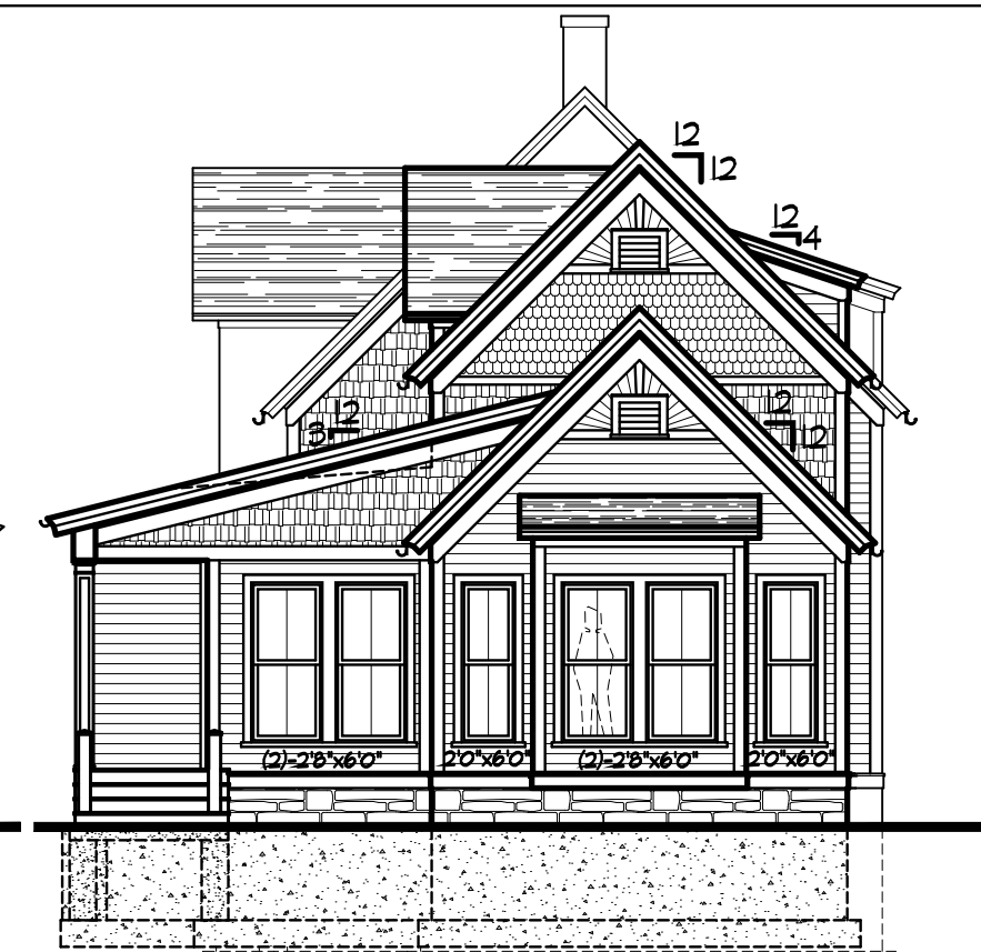
2 PROP. EAST ELEVATION SCALE: 1/8" = 1'-0"
