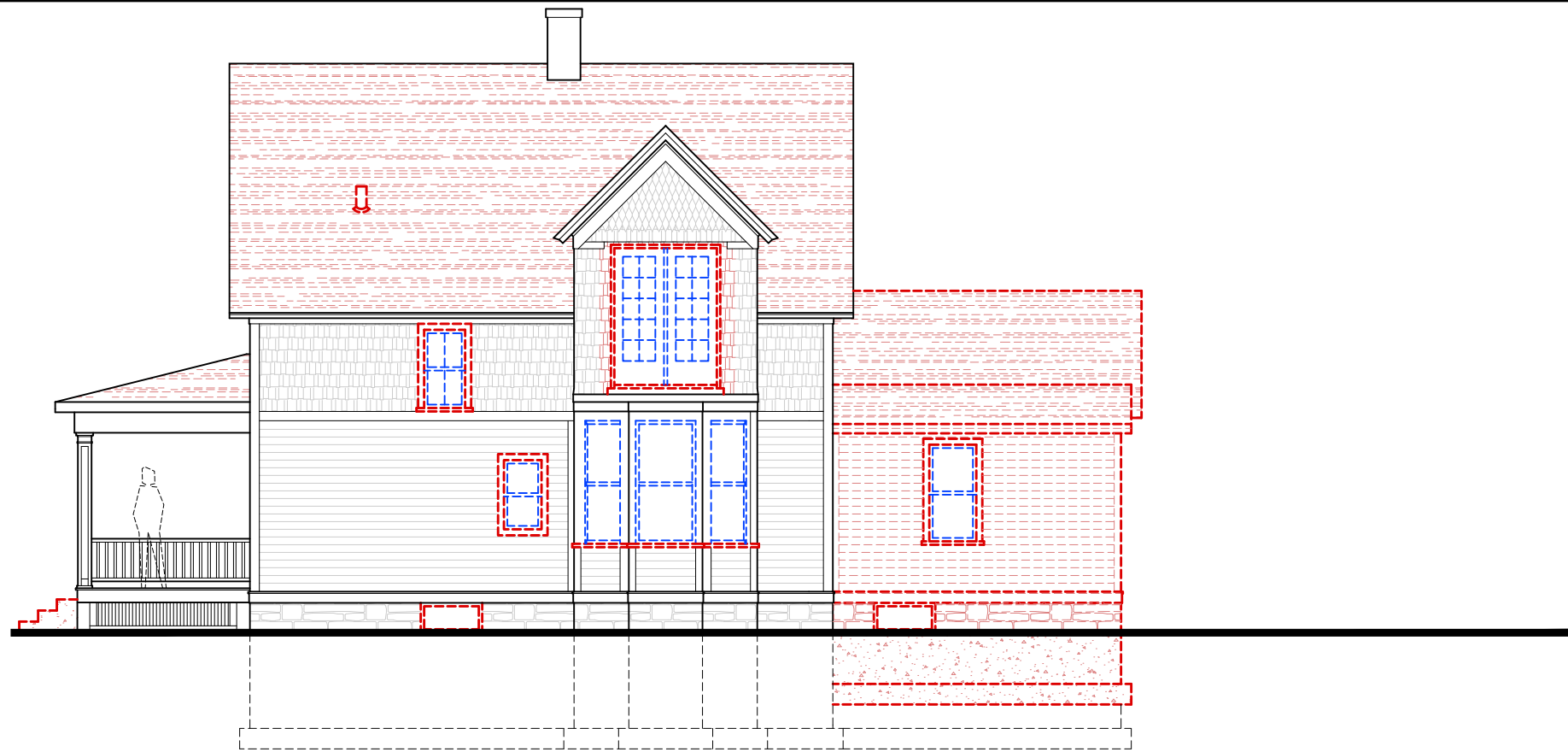
4 DEMO. SOUTH ELEVATION SCALE: 1/8" = 1'-0"
