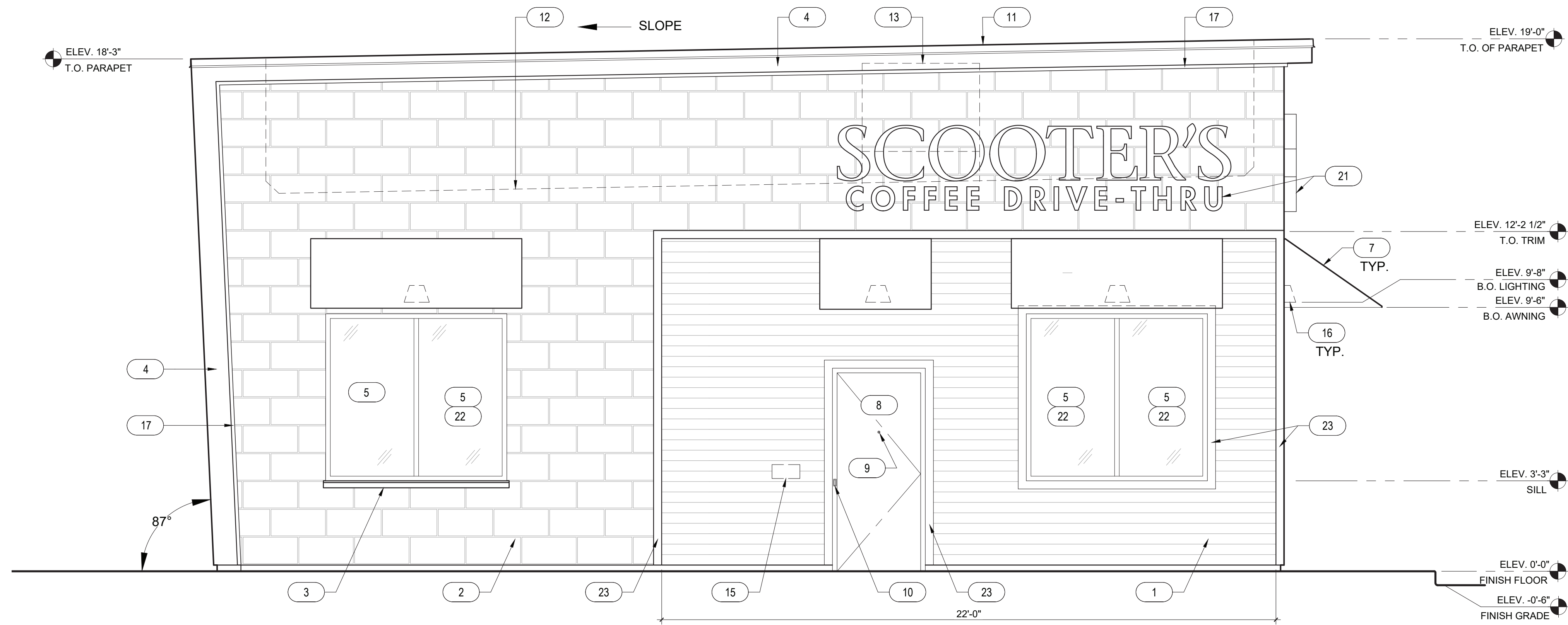
2 NORTH ELEVATION SCALE: 3/8" = 1'-0"
