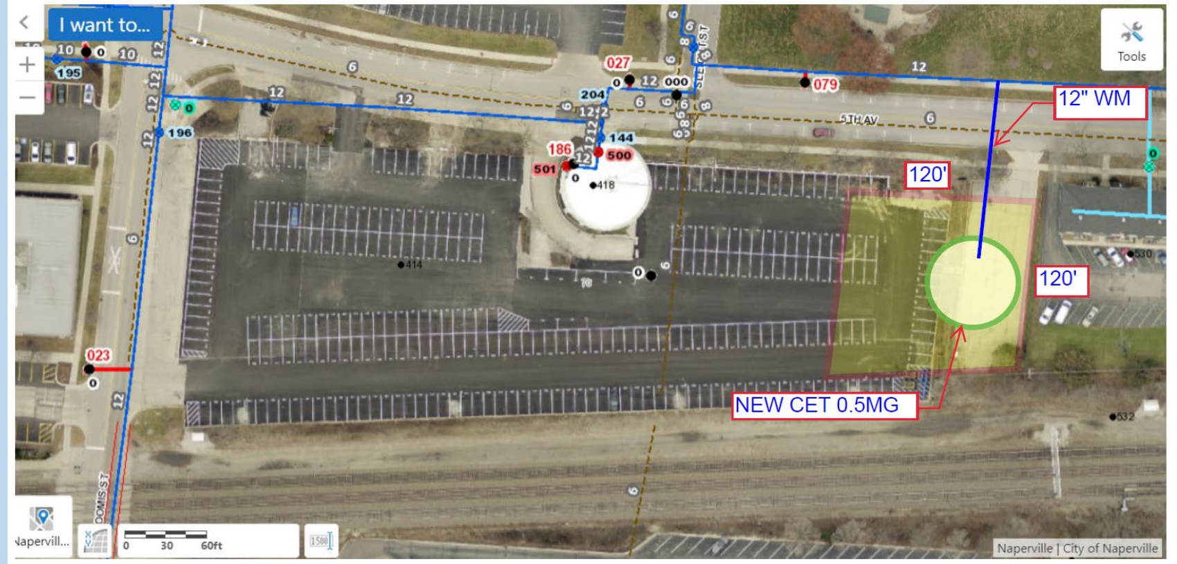
OPTION 1. CET TO BE RELOCATED ONSITE
